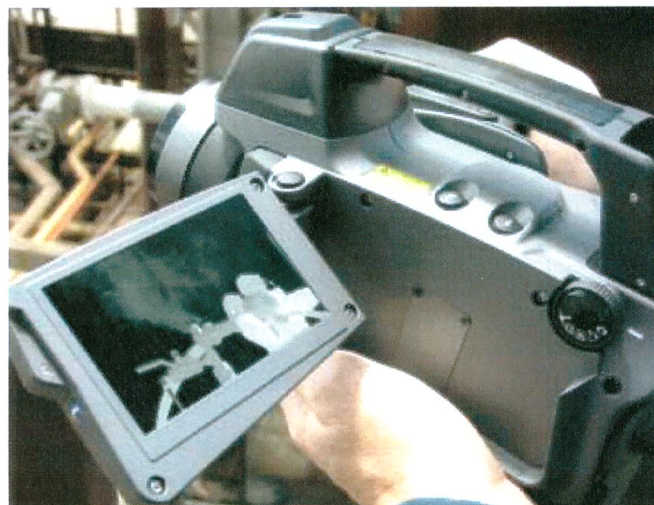
Mit der neig- und klappbaren, kontrastreichen 4,3" Farb-LCD-Anzeige können Sie Ziele sicherer aus jedem beliebigen Winkel betrachten.
