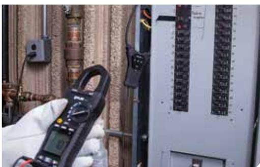
FLIR TA74 im Einsatz an einer FLIR CM83 Strommesszange
